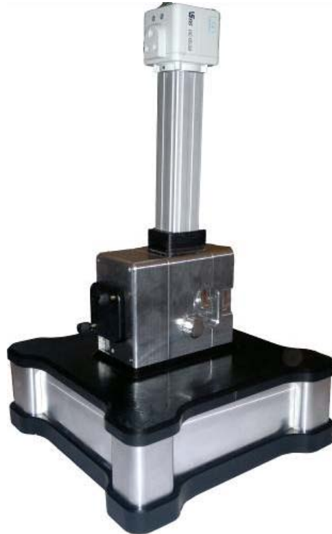
Рис. 5. Прибор для определения аналитов с помощью микромеханической катилеверных датчиков
